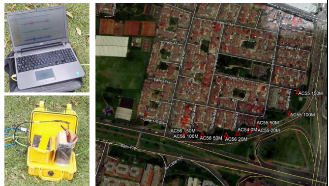
Figura 12 Mediciones de vibraciones ambientales y método SPAC en inmediaciones de Uniagraria
